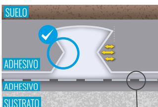
El dibujo exclusivo de la estructura tridimensional de la capa en HDPE permite alcanzar valores de adhesión récord.
