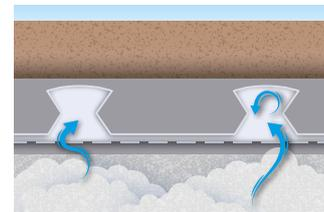
El vapor, generado por una humedad residual excesiva en el sustrato, libera la tensión en las cavidades vacías.
